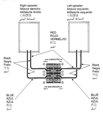
Amplifier output terminals Terminales de salida de amplificador Terminais de saida do amplificador 放大器輸出端子
